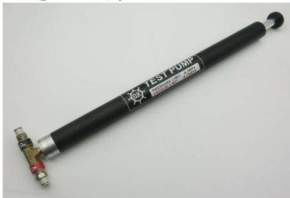
ポンプの V ポート(赤)に圧導入チューブを接続して押し子を操作することで装置の配管内を負圧に引くことができます。
